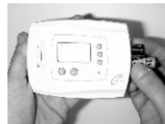
1. Suchen Sie die kleine Klappe des Batteriefachs auf der Seite des Gehäuses.
